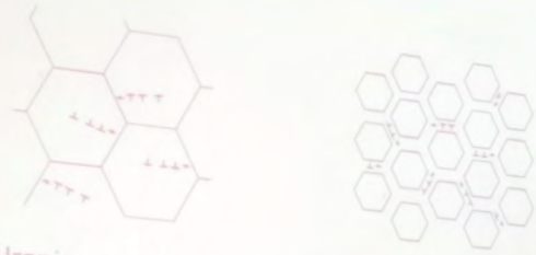
Obr. 1 Hranice zrn (a) hrají roli překážek pro dislokační pohyb mřížky v primárních polykrystalech a (b) působí na změkčení stavebních prvků, které nesou plastický tok v těchto velmi jemnozrnných materiálech
