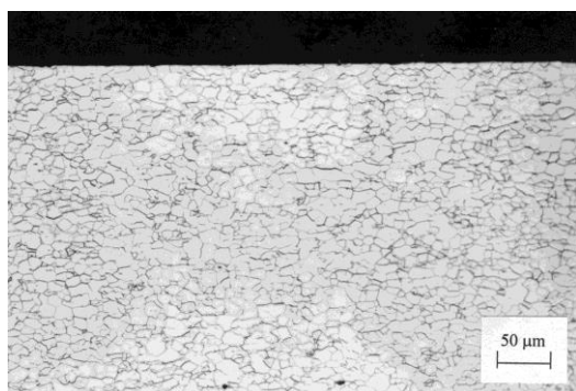
Obr. 1 Příčný metalografický výbrus z plechu z oceli St 4 ve směru 0° vůči směru válcování (leptáno 3 % Nital)
