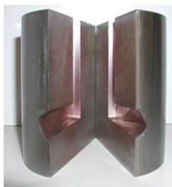
Obr. 4 Nástroj se zabudovanou šroubovicí s úhlem stoupání a) 10 °, b) 30°, c) tvar nástroje
