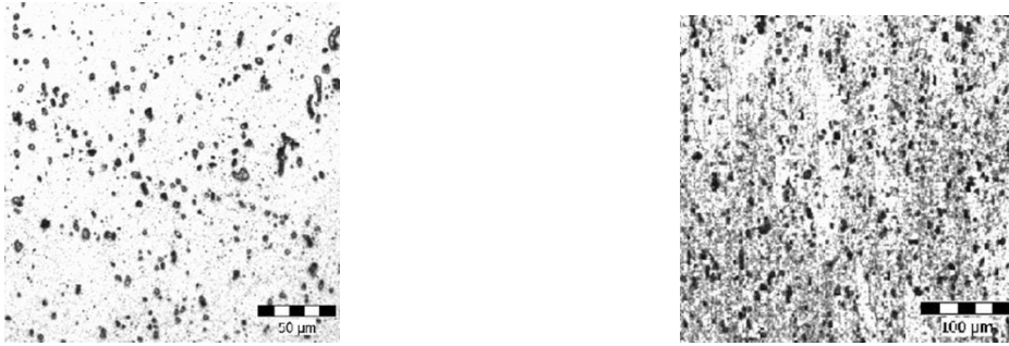
Obr. 5. Metalografická analýza struktury u slitiny AlMn1Cu a) výchozí stav, b) stav po 8. průchodů zařízením DRECE
